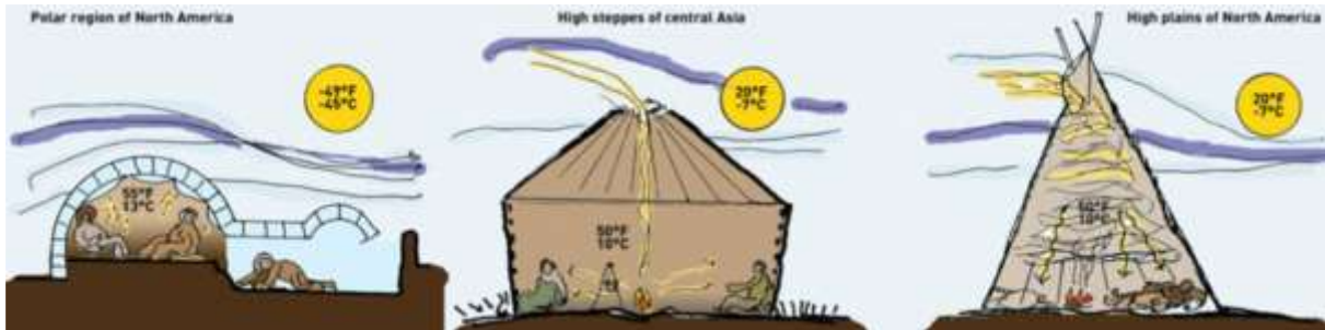
Şekil 5. Çeşitli zorlu iklimlerde yer alan geleneksel yapıların tasarım çözümleri (Bainbridge ve Haggard, 2011).
