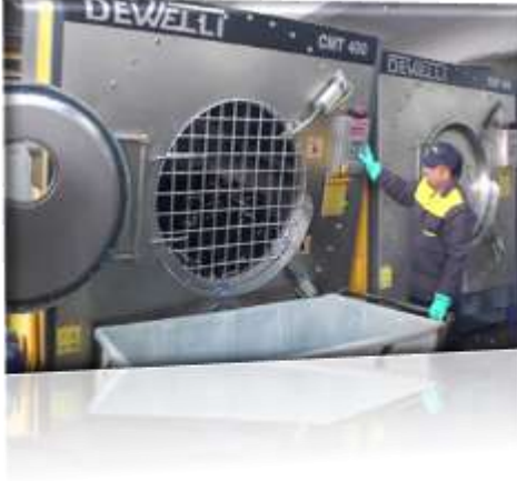
Şekil 1. Denim ürünlerin yıkanması işleminde kullanılan çamaşır makinesi ve pomza taşları.
