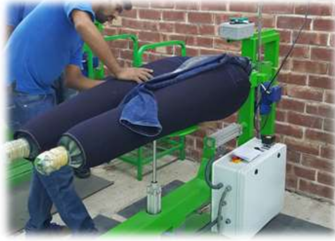
Şekil 3. Su zımparası ile denim ağartma işlemi.
