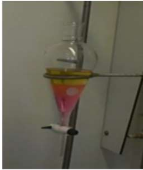
شكل 3: قمع افصل المستخدم لفصل الزيت عن الماء.
