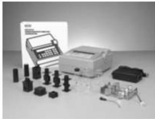
شكل 2: جهاز Spectrometer HACH DR 2010
