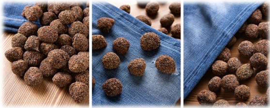
Şekil 2. Pomza taşına alternatif olarak üretilmiş sentetik polimer taşlar.
