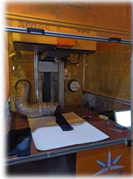
Şekil 4. Lazer cihazı ile denim ağartma işlemi.
